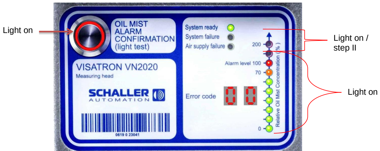
Figure 62: Beispielanzeige LED Display mit Alarm
